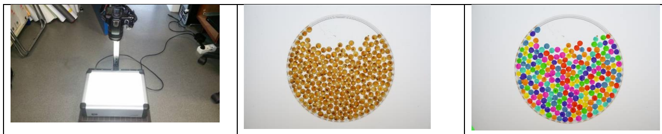
Figure 14 : Négatoscope de prise de vue, image obtenue et la même image traitée pour compter les œufs et estimer leur surface individuelle.
