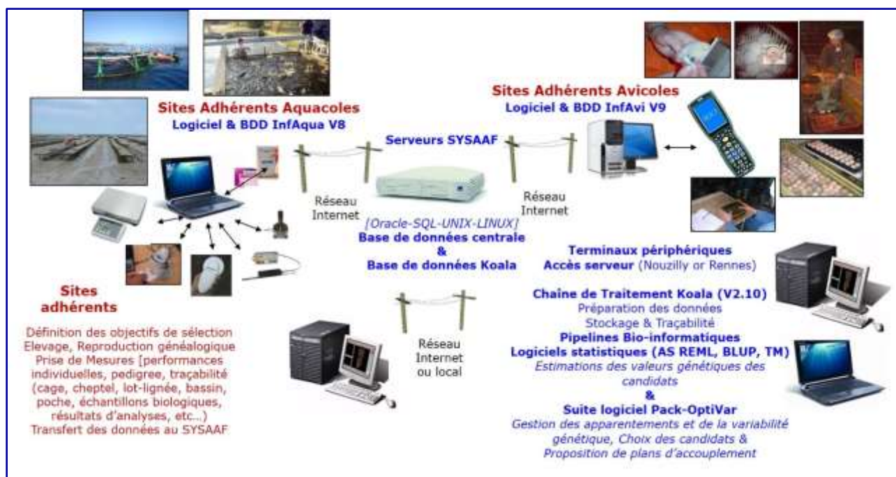
Figure 16 : Schématisation des outils informatiques mis en œuvre chez les adhérents du SYSAAF et en interne, dans le cadre de la mission d'appui technique à la gestion et à la sélection génétique des espèces aquacoles et avicoles
