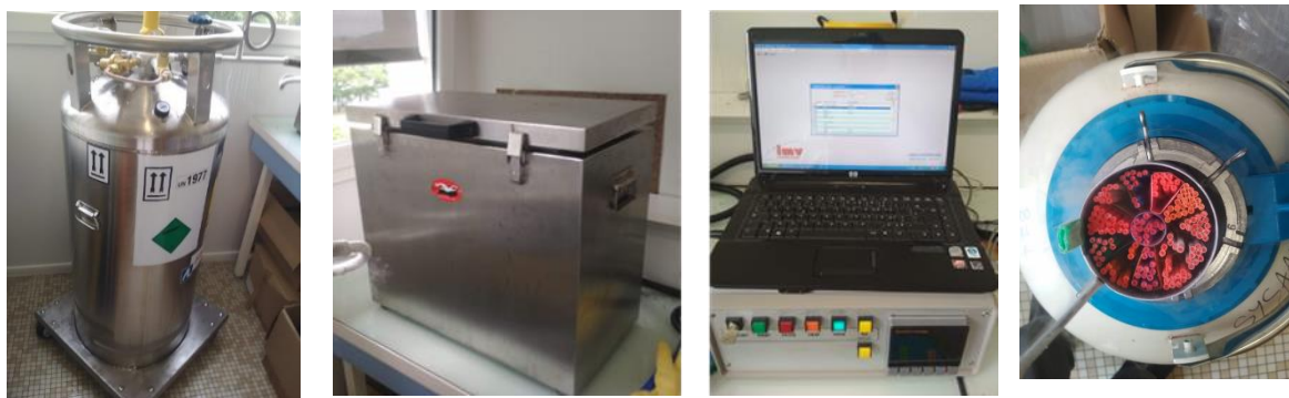
Figure 19 : Nouvelle cuve cryogénique SYSAAF (120 litres) et illustrations du matériel utilisé pour la constitution des stocks de la collection aviaire de la cryobanque nationale
