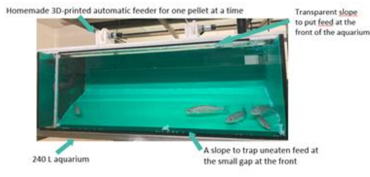
Vu d'ensemble d'un aquarium modifié pour la mesure de l'ingestion alimentaire.
